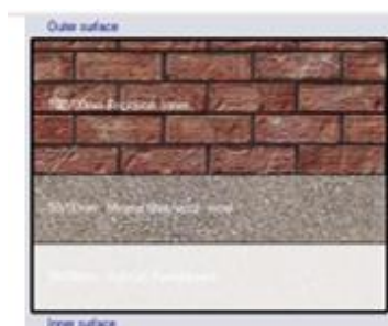
شکل (۲۰): آجر توخالی، پشم سنگ و گچ
