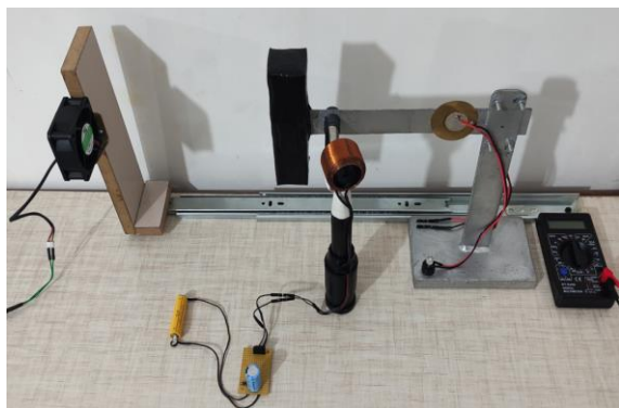
شکل (۹): سیستم برداشت انرژی از جریان باد بر مبنای پدیده گالوپینگ
