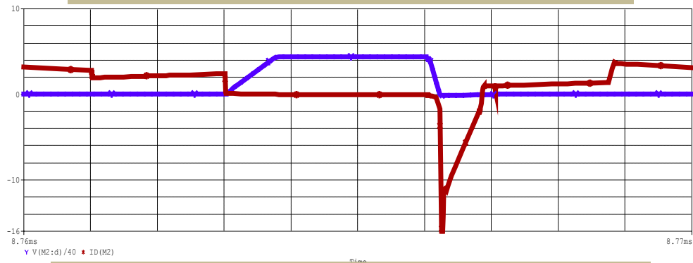
شکل (۸): موج جریان (قرمز) و ولتاژ (آبی) سوئیچ M_2 (مقیاس 1 \mu\text{s/div} , 2\text{A/div} , 80\text{V/div} )
