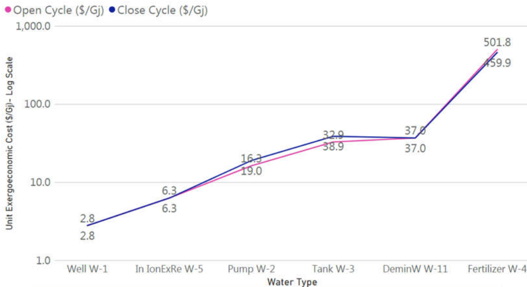
شکل (۲): مقایسه‌ی مقادیر C برای جریان‌های مختلف آب در سیستم هیدروپونیک باز و بسته در مقیاس لگاریتمی
