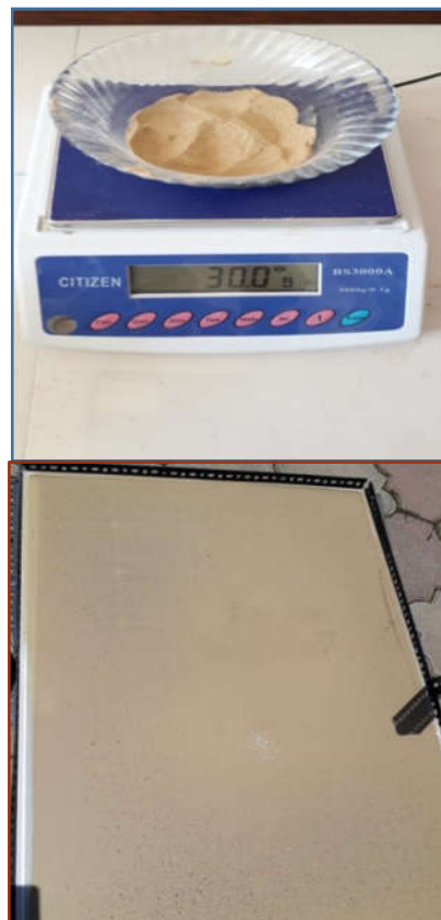
شکل (۴): ریزگرد مورد استفاده در آزمایش: توزین ریزگرد (بالا) و ریزگرد نشست کرده روی سطح پنل (پایین)
