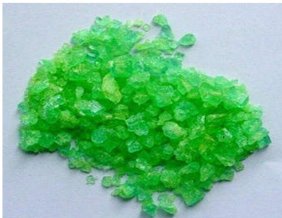
شکل (۶): کلرید آهن (FeCl 2 .4H 2 O) حاصل از مدار اسیدشویی
