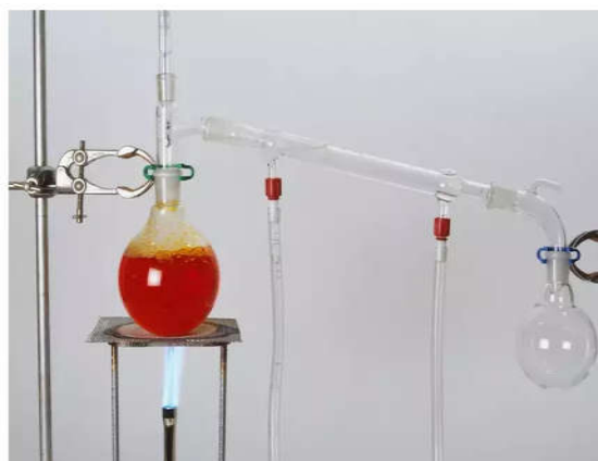
شکل (۵): طرح‌واره تبخیر پساب واحد اسیدشویی در فاز آزمایشگاهی
