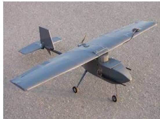
شکل (۱۴): قسمت‌های ساخته‌شده بدنه هواپیما
