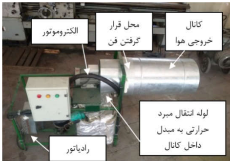
شکل (۳): دستگاه مه‌پاش ساخته شده
