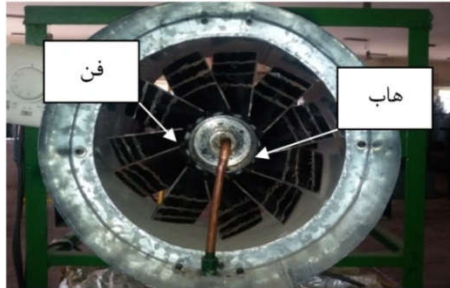
شکل (۴): پره نصب شده در کانال دستگاه مه‌پاش
