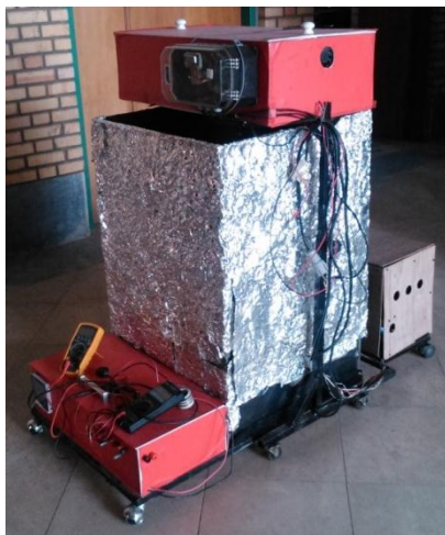
شکل (۱): دستگاه آزمون عملکرد پنل خورشیدی مجهز به محفظه کنترل شرایط محیطی دما و رطوبت
