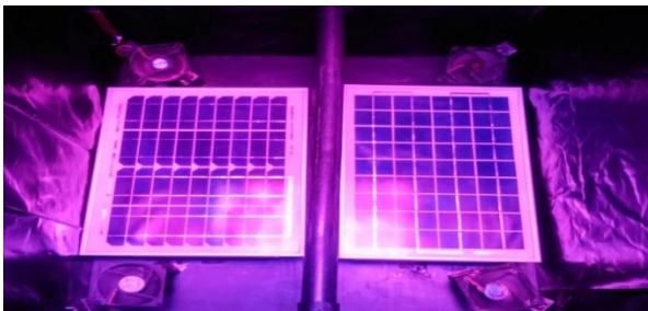
شکل (۳): محفظه آزمون و کانال شیاردار
