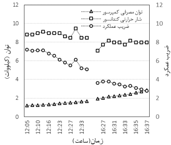
شکل (۱۰): ضریب عملکرد و توان تولیدی و مصرفی پمپ حرارتی
