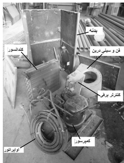
شکل (۱): اجزای جداسازی شده نمونه انتخابی پمپ حرارتی تجاری
