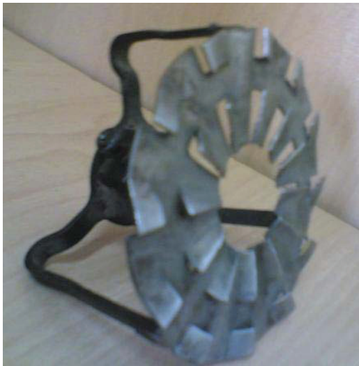
شکل (۲): پره تولید چرخش در جریان هوای ورودی
