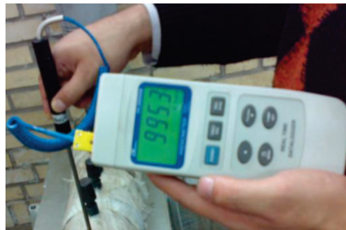
شکل (۳): اندازه‌گیری دمای کوره در فاصله ۶۰۰ میلی‌متری از ابتدای آن
