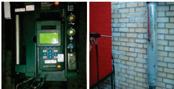
شکل (۵): نمونه‌گیری از گازهای خروجی دودکش و دستگاه آنالیز گاز
