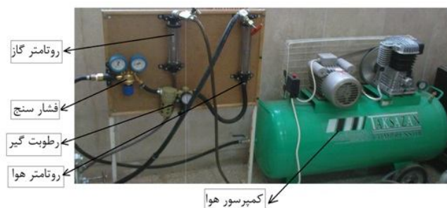
شکل (2): نحوه اتصال فیلتر هوا و رواترها به کمپرسور
