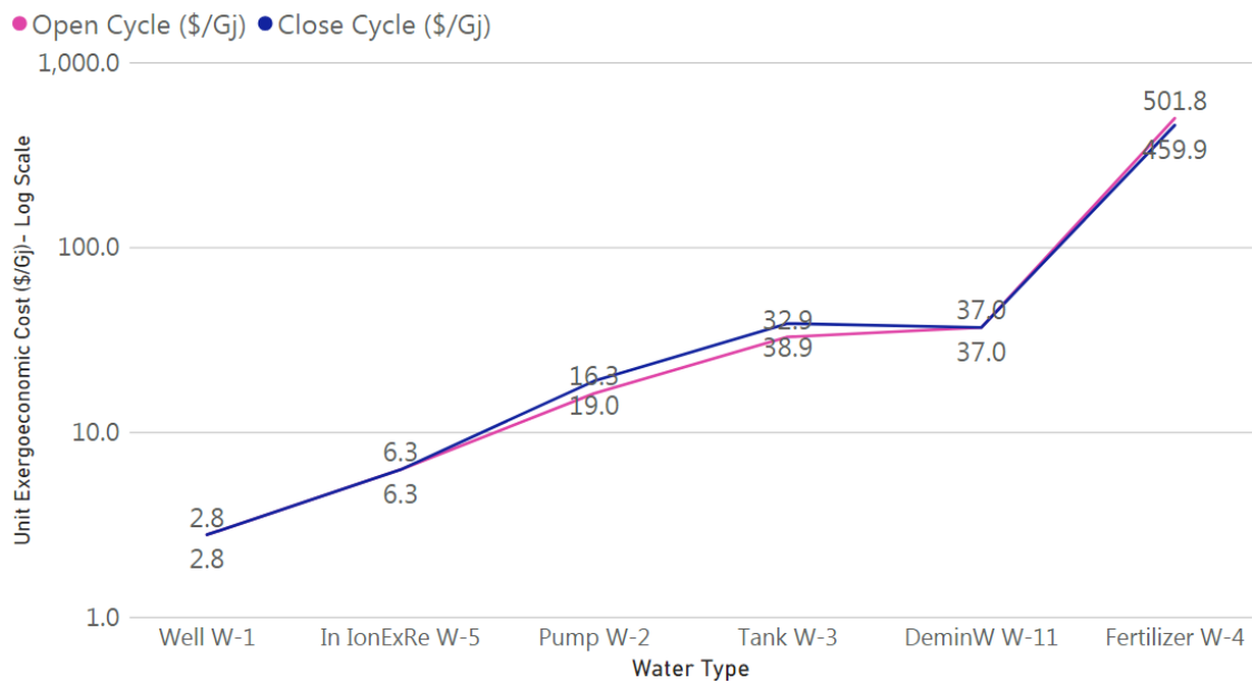
شکل (۲): مقایسه مقادیر c برای جریان‌های مختلف آب در سیستم هیدروپونیک باز و بسته در مقیاس لگاریتمی
