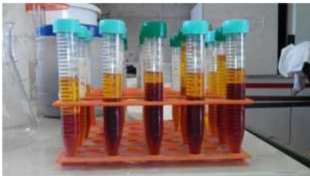
شکل (۴): نمونه‌های فازهای جداشده پس از استفاده از سانتریفیوژ. فاز غنی از دیزل زیستی بالا و فاز غنی از گلیسرین پایین
