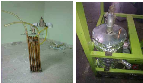
شکل (۶): مبدل حرارتی نوع پوسته و لوله مورد استفاده (الف) نمای کلی (ب) لوله‌های مسی مورد استفاده (ب)
